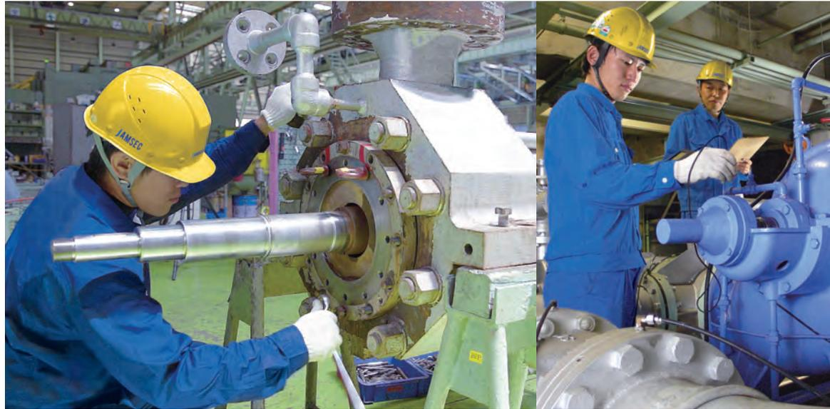
工場の心臓部である回転機械を整備する仕上げ工。大型コンプレッサーから小型ポンプまで、幅広い知識と繊細な技量で現場を支えています。
